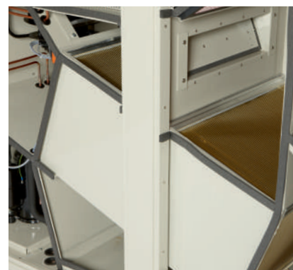
Высокоэффективные рекуператоры выполнены из алюминия с эпоксидным покрытием, предохраняя их от воздействия хлорсодержащего воздуха бассейна.
